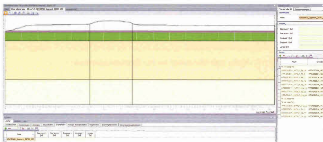
← Figuur 3.41: De combinatie van een 1D profiel en een hoogtegeometrie is een nieuw 2D profiel.
